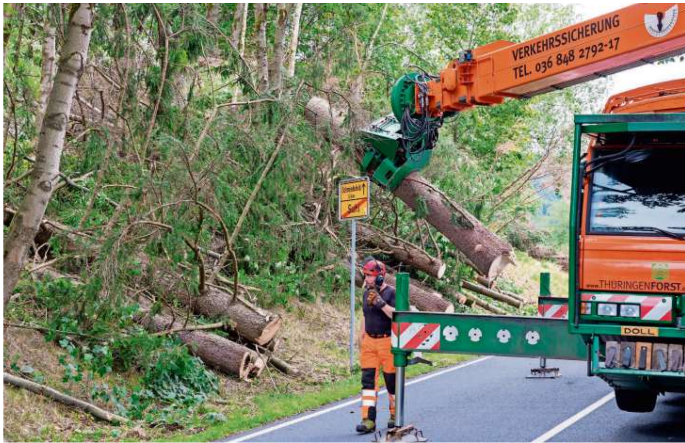
Das kaputte Holz muss weg: Mitarbeiter des Thüringen-Forst fallen mit Hilfe eines sogenannten „Tree Trimmer“ Bäume entlang der Verbindungsstraße zwischen Suhl und Schmiedefeld. Das gefällte Holz wird anschließend direkt zu Hackschnitzeln verarbeitet. Foto: ari
