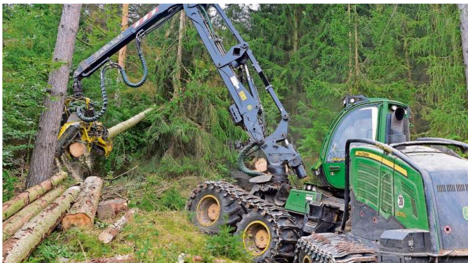
Ein Harvester fällt im Revier „Am Grundhof“ Bäume, die vom Borkenkäfer befallen sind.
